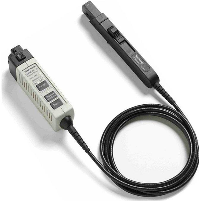
TCP0030A는 TekVPI™ 프로브 인터페이스를 사용하여 오실로스코프에 직접 연결하도록 설계되어 용이성을 갖춘 고성능 AC/DC 전류 프로브입니다. 이 AC/DC 전류 측정 프로브는 5A 및 30A 측정 범위 중 선택 가능하며 120MHz 이상의 대역폭을 제공합니다. 또한 최신 전류 측정 요구 사항을 충족하는데 있어 중요한 요소인 우수한 저전류 측정 기능과 1mA의 전류 레벨 정확도도 제공합니다.
